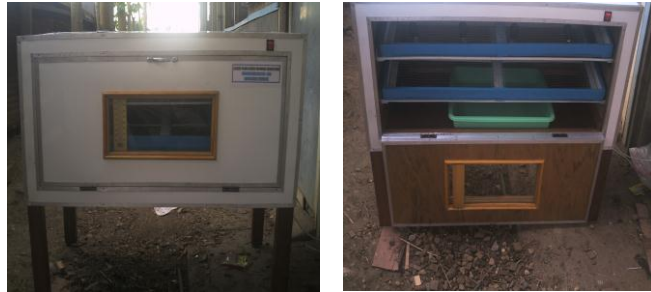
Gambar 4.4. Mesin tetas manual berbantalan gabah padi; tampak depan (kiri) dan tampak dalam (kanan)
